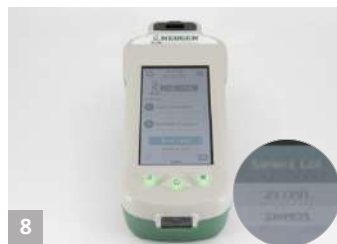
8 Виберіть категорію тесту на антибіотики у молоці, номер тесту та номер партії на екрані
