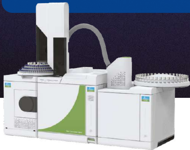
Газовий хроматограф Clarus® Nova
