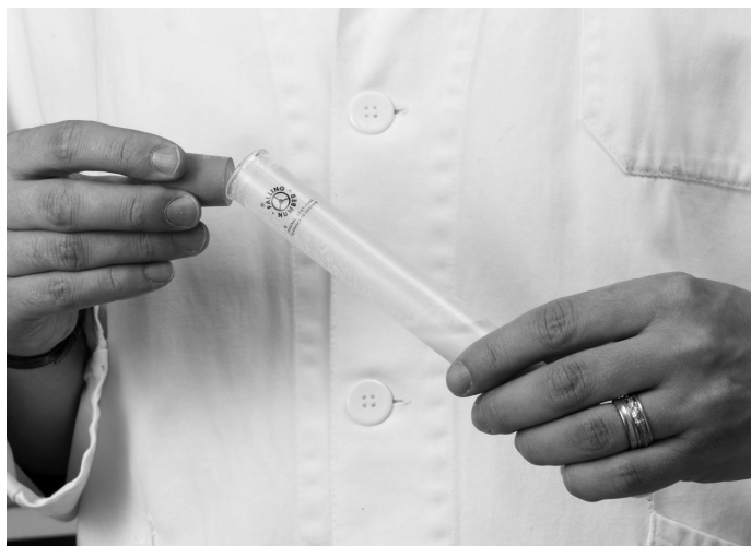
Рис. 11. Удаление остатков образца с пробки
