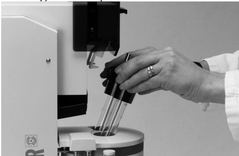
Рис. 14. Поместите кассету с вискозиметрическими трубками в водяную баню.
