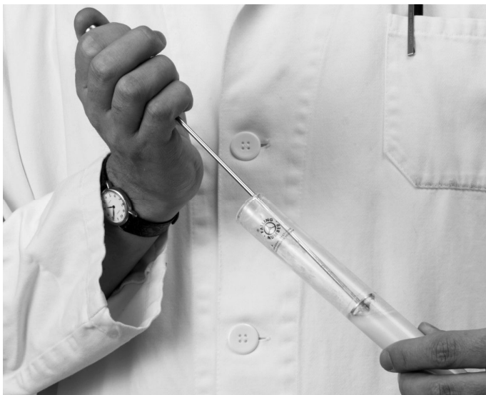
Рис. 12. Перенос остатков образца со стенок в суспензию
