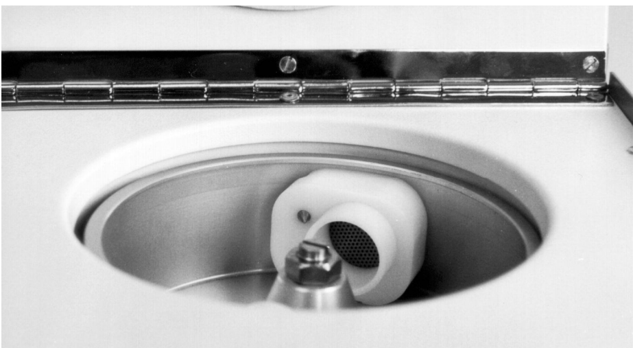
Рисунок 5. Правильно установленные центрифужные кассеты.
