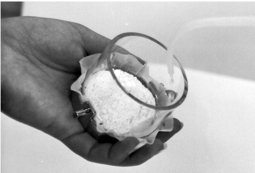
Рисунок 6. Добавление воды для смешивания образца. Струя воды направлена против боковой стенки.
