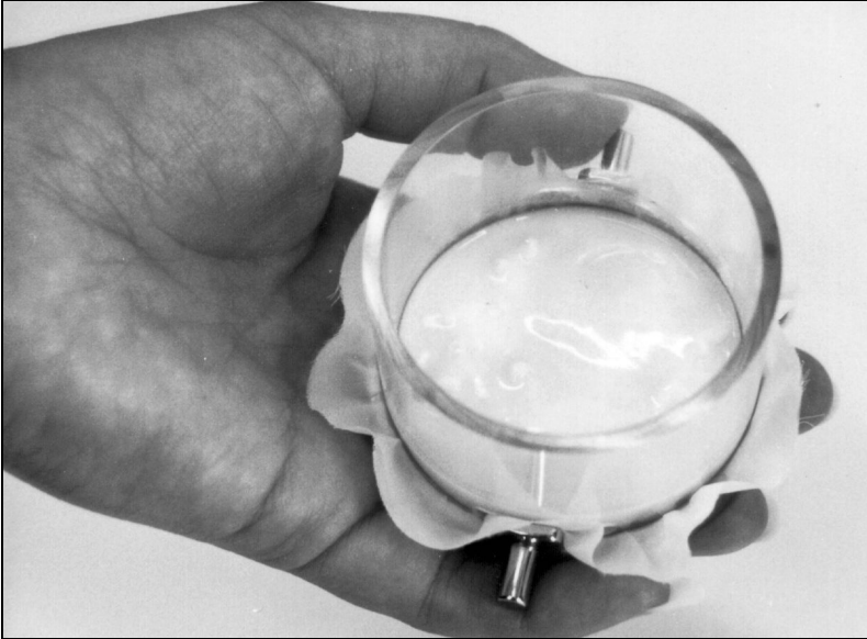
Рисунок 7. Равномерное распределение воды поверх исследуемого образца.
