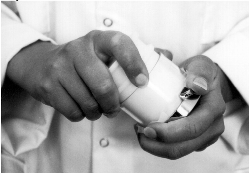
Рисунок 4. Сборка промывной камеры. Мелкое сито в немаркированном держателе.
