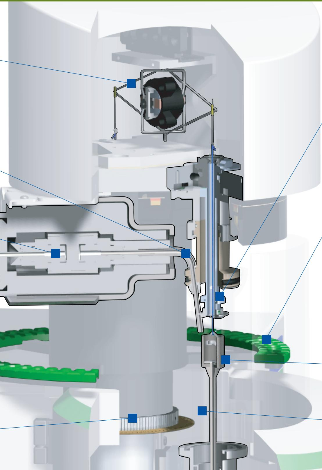
Трубка газа реакционной среды позволяет добавлять газ непосредственно в зону образца и подключается к дополнительному устройству для смешивания газов (GMD 8000), благодаря которому можно смешивать до трех газов.
