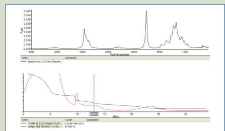
В данном примере пластификатор легко установить, изучив ИК-спектр во время потери веса в процессе испарения пластификатора (в точке, соответствующей 13-й минуте эксперимента) и сравнив результат с данными в справочной библиотеке.
