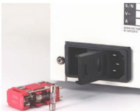
Рис. II-1. Отсек для предохранителей открыт, кассета с предохранителями (230 В, 5 × 20 мм) извлечена из отсека.
