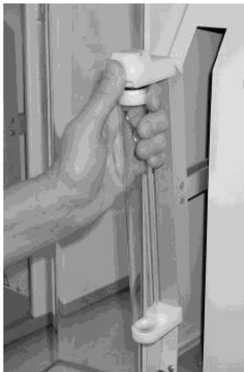
*Рис. 5. Аккуратно извлеките трубку из держателя, потянув ее за верхний конец.*
