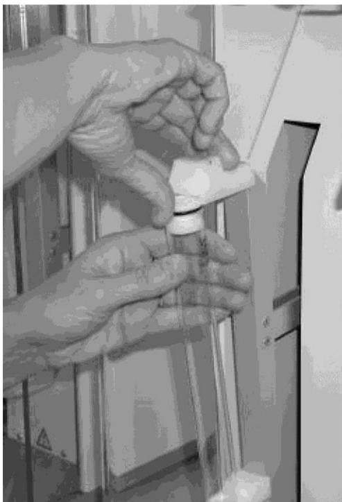
*Рис. 4. Вставьте нижний конец трубки в углубление держателя, после чего нажмите на верхний конец трубки, чтобы вставить его в верхнюю часть держателя.*
