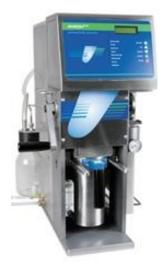
Компания **ANKOM Technology** представляет приборы для эффективной и экономичной экстракции растворителем. Экстрактор **ANKOM XT** был подвергнут тщательному тестированию в широком диапазоне типов образцов. Прибор позволяет определять содержание жира в образцах с маслосодержанием в диапазоне от **0% до 100%**.
